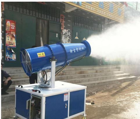
喷雾炮是根据风送原理，先使用进口高压泵、微细雾化喷嘴将水雾化，再利用风机风量和风压将雾化后的水雾送到较远距离，使得水雾到达较远距离同时能够覆盖更大面积，水雾与粉尘凝结后降落，从而达到降尘目的。
