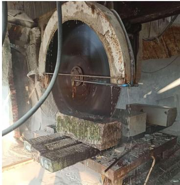
喷淋除尘是用水与含尘废气相互接触，从而实现分离捕集粉尘粒子，在现代除尘工艺中已得到广泛应用。根据《实用环境工程手册——大气污染控制工程》（2001）吴忠标主编 化学工业出版社、《逸散性工业粉尘控制技术》等实施喷淋除尘除尘效
